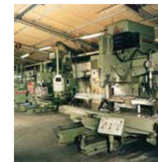
Kopierfräse mit Modellabtastung - Profile milling machine with model scanner
