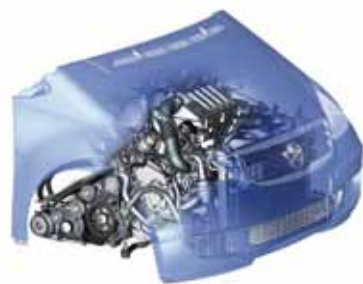
Sandwich-Bauweise: Durch die teilweise Verlagerung des Antriebs unter den Innenraum sollte mehr Raum für die Fahrgäste geschaffen werden; die Sicherheit der Insassen erhöhte sich dadurch zusätzlich.
